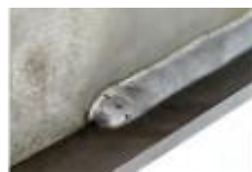
Без заваривания концевго кратера
